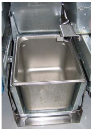
Bild 3: Sätt i den inre oljebehållaren i smältenheten.
