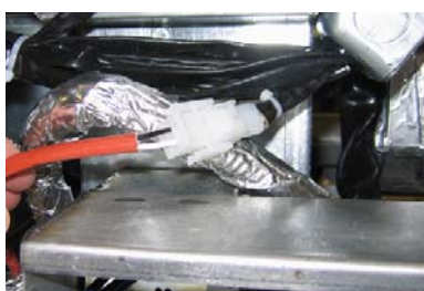
Bild 6 Fäst de vita tvåstiftskontaktarna och koppla in den svarta kontakten i elskåpet såsom visas. * Notera att placeringen av den svarta kontakten kan skilja sig från den på bilden.
