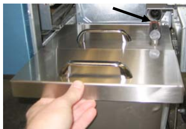
Bild 4: Placera locket på behållaren och dra på oljeupptagningsslangen på suganslutningen.
